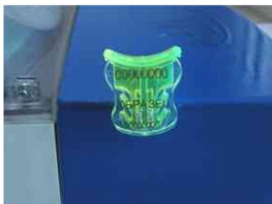
**5. Проверить надежность установки путем попытки «сдергивания» пломбы с объекта**
