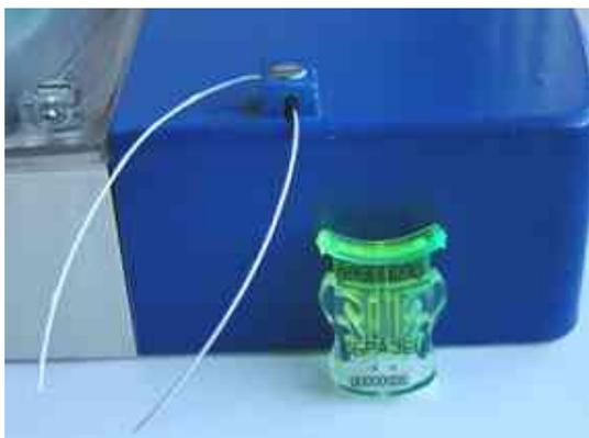
**1. Пломбировочный трос завести в отверстия пломбируемого объекта.**
