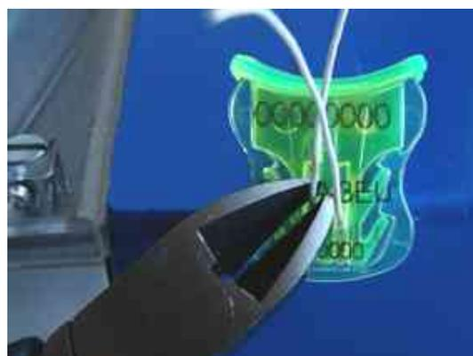
**4. Убедиться в полном защелкивании вставки в корпусе и обрезать лишние концы пломбировочного троса**
