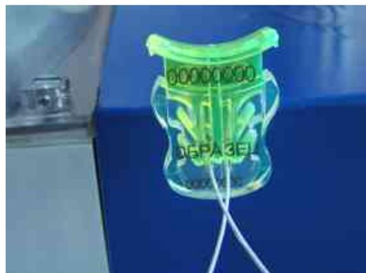
**2. Свободные концы троса продеть через отверстия в корпусе пломбы и приблизить пломбу на минимальное расстояние к пломбируемому объекту.**
